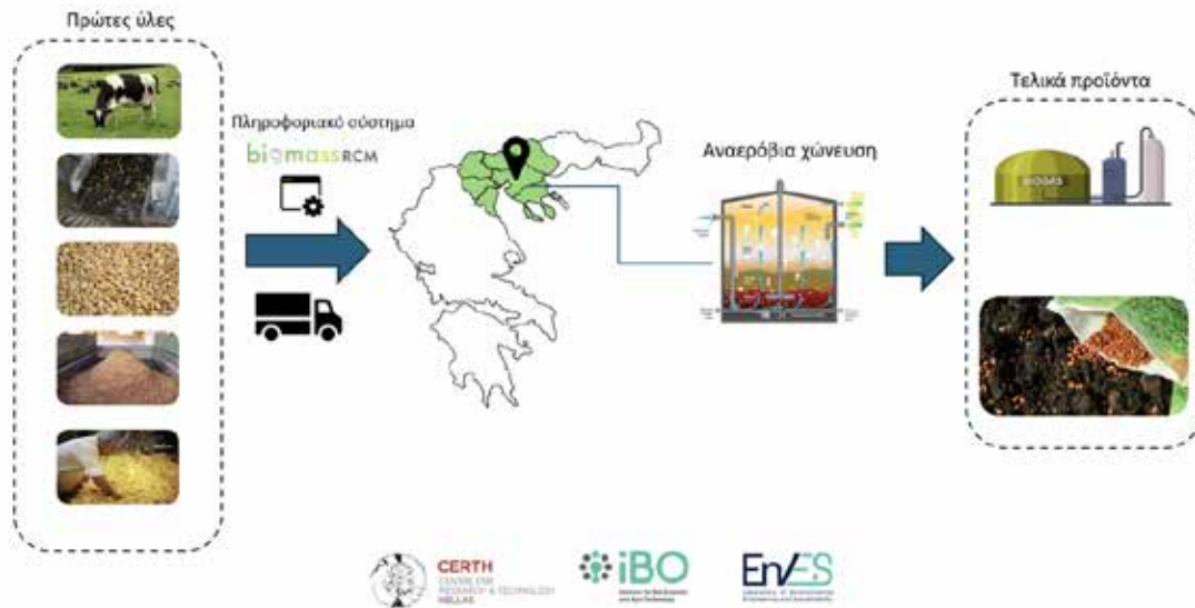
Εικόνα 1: Σχηματική περιγραφή ορίων συστήματος «BiomassRCM»
